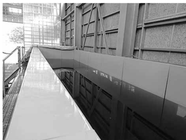
▲ 大型酸洗槽は長さ7mまで対応可能
