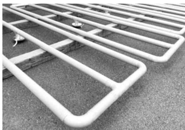
▲ 酸洗い後(溶接焼けが除去)
