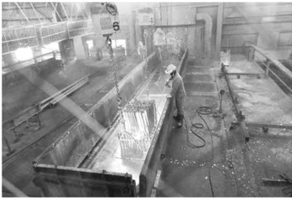
▲ めっき槽での作業
