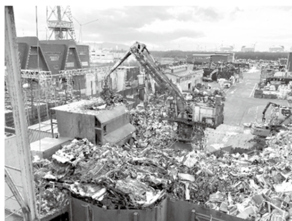
▲ 金属スクラップを粉碎し、鉄、非鉄金属に仕分け
