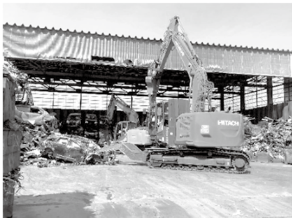
▲ 部品回収済車両は重機で金属類と他素材に選別
