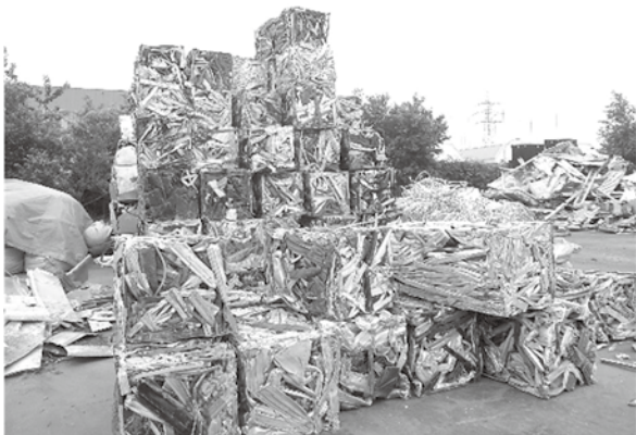
▲ 再生利用の対象となる廃サッシ部材
