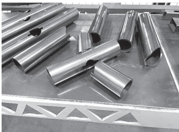
▲3Dレーザー加工機の試作品
