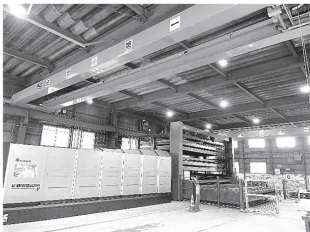
▲導入した10kwファイバーレーザー切断機
