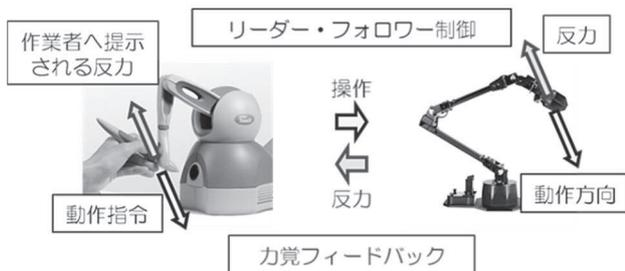
図 14 ロボットアームの制御
