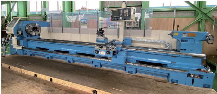
大日金属製 DLX85A-500 (φ900× 300L 程度の加工からφ600× 5000L までの長尺ワークに対応)
