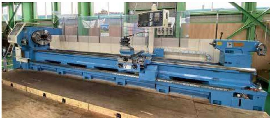
大日金属製 DLX85A-500 (φ900×300L程度の加工からφ600×5000Lまでの長尺ワークに対応)
