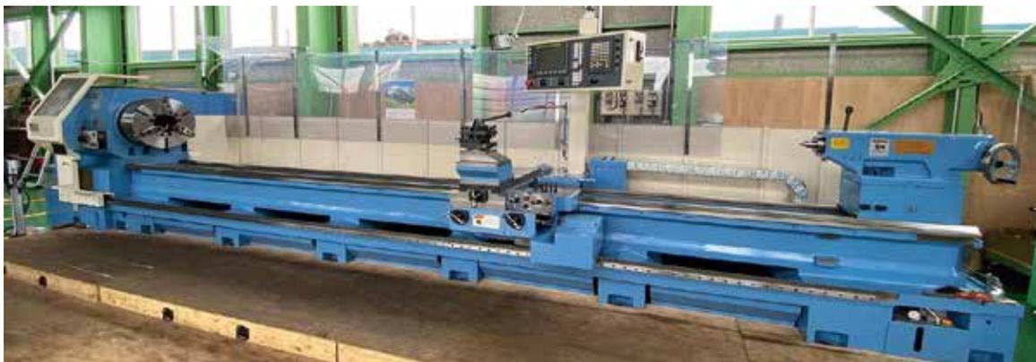
大日金属製 DLX85A-500 (φ900×300L程度の加工からφ600×5000Lまでの長尺ワークに対応)
