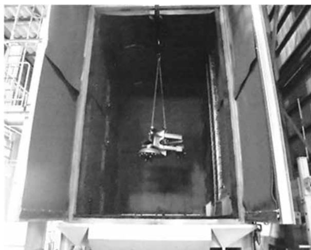
大型製品研掃も可能な Sinto 大型ショットブラスト
