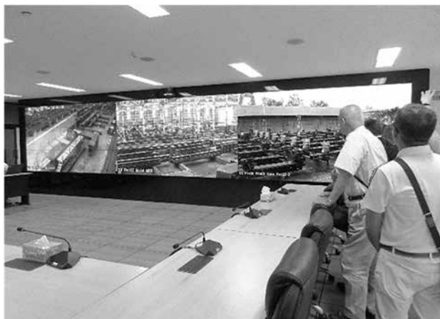
壁一面のモニターで、工場内の監視、製作管理システムの状況確認を行っていました。監視カメラは、高精細なうえズームや角度振りが可能で製品検査にも活用しているそうです。
