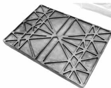
評価用鋳物(最適形状, 裏面)
