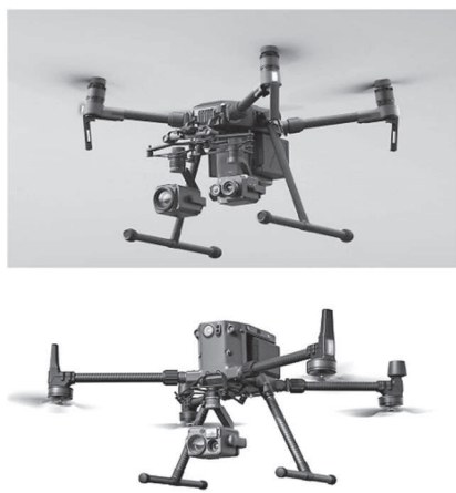
図5 ドローンとサーモグラフィー （上:Matrice210, 下:Matrice300 RTK）
