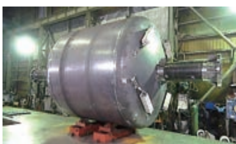
【室蘭港第二号灯浮体ユニット部】
