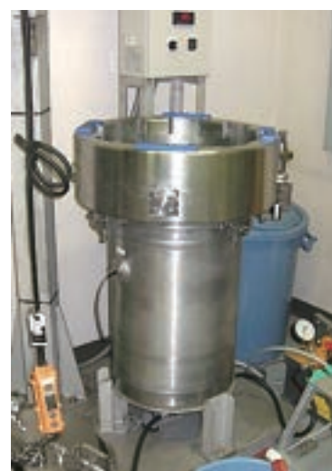
【12Mpa水圧試験機】 (北大水産学部設置)
