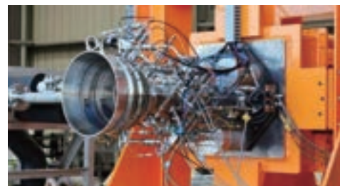
【ZEROのエンジンCOSMOSの燃焼器】
