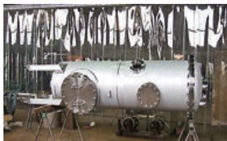
【SUS製 某メーカー向濾過機】
