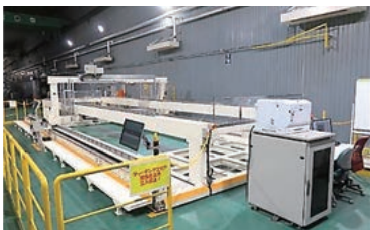
【C-San自動UT装置】
